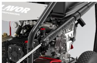
Moteur Diesel Yanmar L100V, tableau de démarrage électrique avec voyants de commande, ralentisseur automatique de tours
