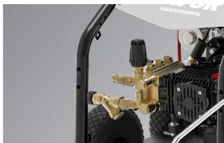
Nouvelle pompe CL 6.0 auto-amorçante à trois pistons en céramiques intégrale, double visière à huile et tête en laiton. Réducteur de régime entre le moteur et la pompe. Nouvelle vanne de régulation de pression à bride L3.1
